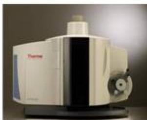
**Эмиссионный спектрометр с индуктивно-связанной плазмой iCAP 6500**
