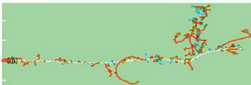
*Одна из возможных траекторий движения иона и атомов полимерных молекул во время ионно-плазменной обработки поверхности материала, вычисленная с использованием программы SRIM&TRIM*
