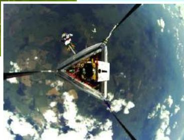
*Вид на платформу с нагревательной установкой, управляемой бортовым компьютером*
