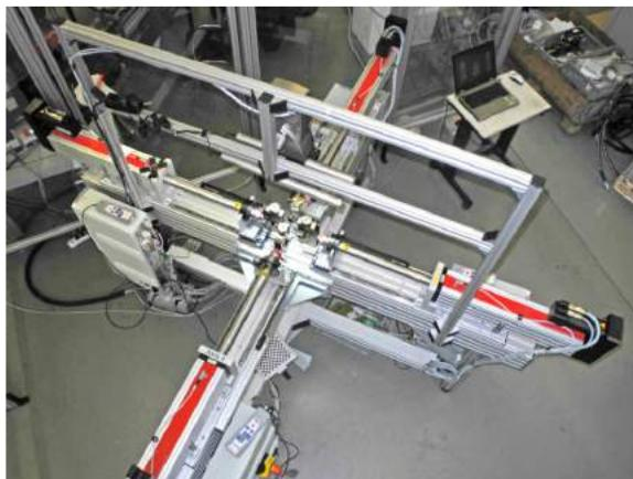
*Уникальный стенд для двухосного деформирования эластомерных материалов*
