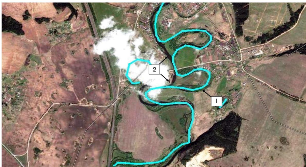
Рис. 3. Спрявление излучин через шпору: 1 – русло реки в конце XVIII в.; 2 – спрявление через шпору в XIX–XX вв.
