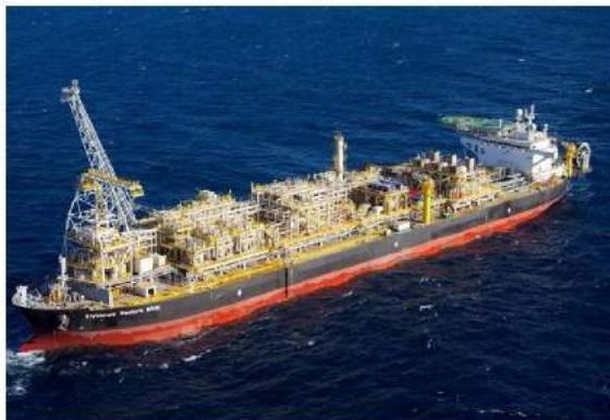
**Рис 1.** Плавучая система добычи, хранения и выгрузки нефтепродуктов
