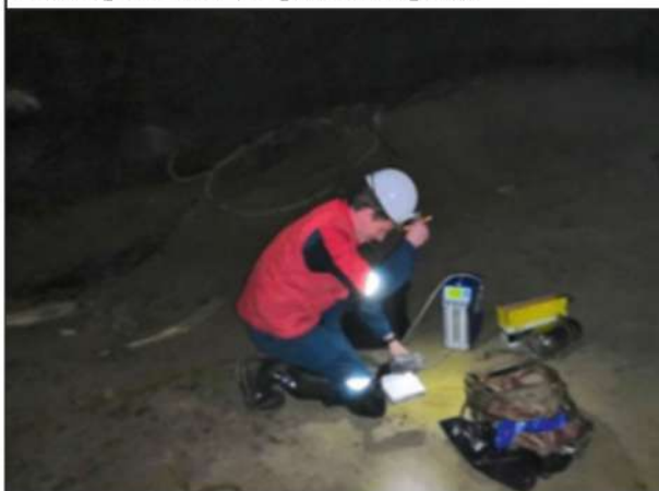
Фото 2. Отбор проб воздуха, рассолов и осадка в руднике Верхнекамского месторождения солей (Пермский край)
