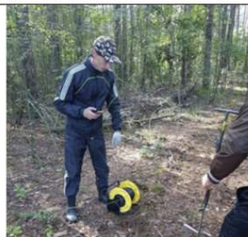
Фото 2. Выполнение геофизических исследований методом вертикального электрического зондирования (ВЭЗ)
