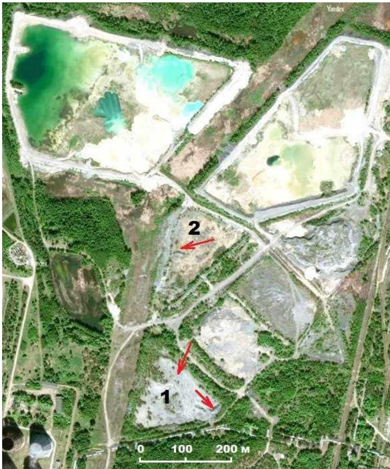
Рис.10.2. Шламонакопители: сверху два действующих, в центре закрытые; из них в № 1 слив шламов прекращен в 1989 г. и в № 2 – в 2005 г. Стрелки указывают места фотографирования. N 58°01'15" E 55°53'28" и N 58°01'29" E 55°53'32".
