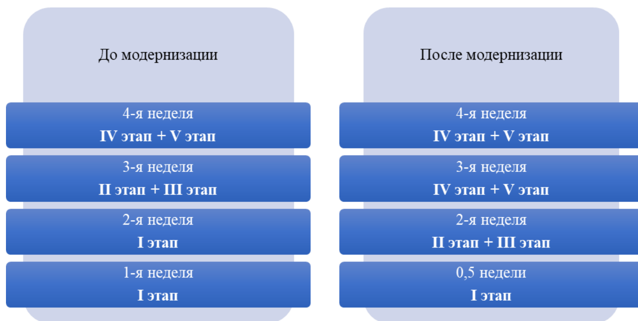
Рис. 7. Этапы обработки данных и выполнения Расчета до и после модернизации программного комплекса Составлено по ист. [1,5,9]
