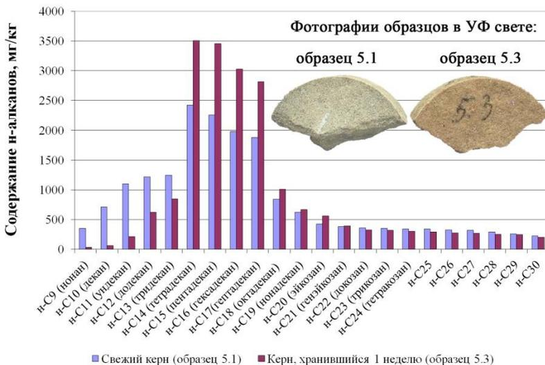
Рис. 2. Распределение n-алканов в экстрактах нефти на различных этапах хранения нефтенасыщенных образцов керна
