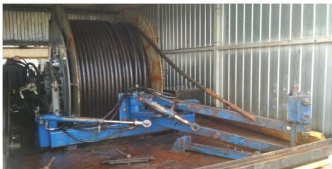
Рис. 2. Технологическое оборудование несамостоятельного каротажного подъемника
