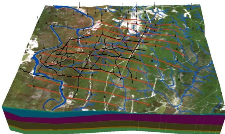
Рис. 1. Схема структурной модели разреза надсолевой толщи исследуемого участка по скважинным данным с учетом топографии местности
