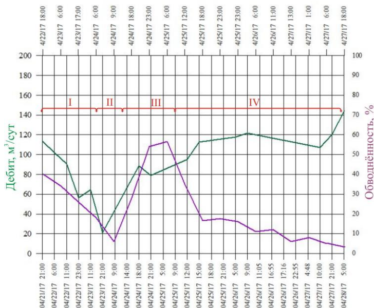
Рис. 3. Графики изменения дебита и обводнённости получаемой продукции при освоении скважины на различных режимах работы ЭЦН
