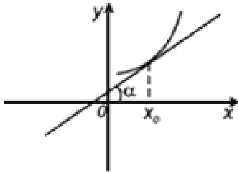
Рис. 55. Геометрический смысл производной
