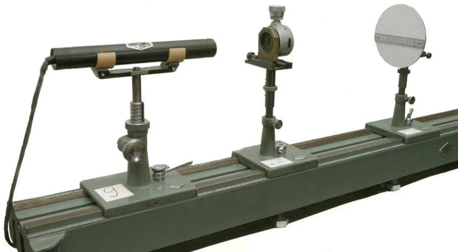
Рис. 1. Лабораторная установка для изучения дифракции света на одной щели
