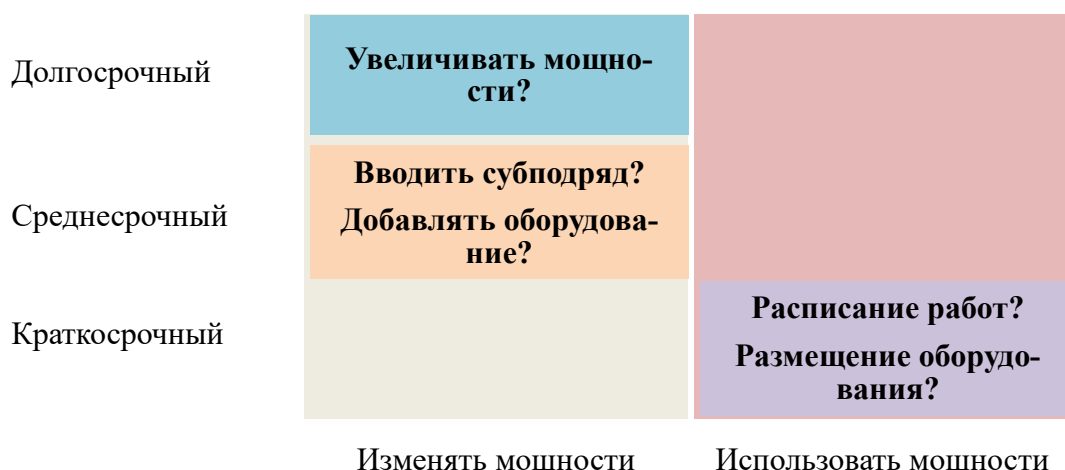
Рис. 14. Временной горизонт при управлении производственными мощностями
