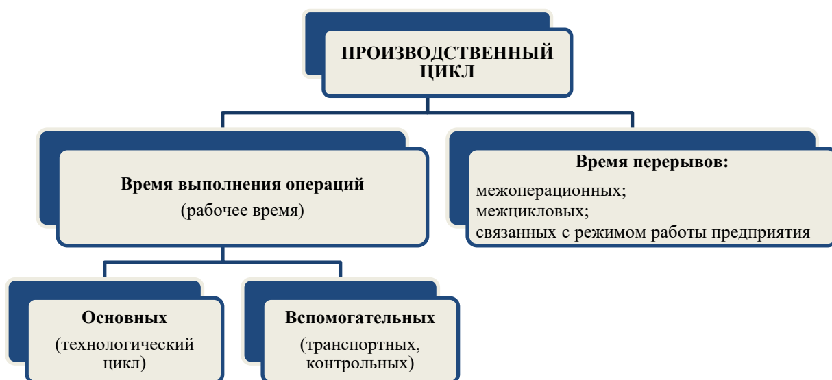
Рис. 5. Структура производственного цикла
