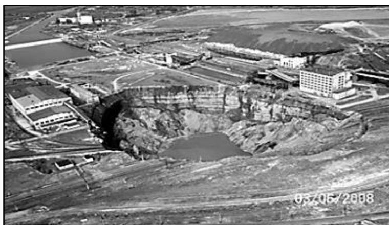
Рис. 2.2. Верхнекамское месторождение солей. Провал над затопленной шахтой БКРУ-1
