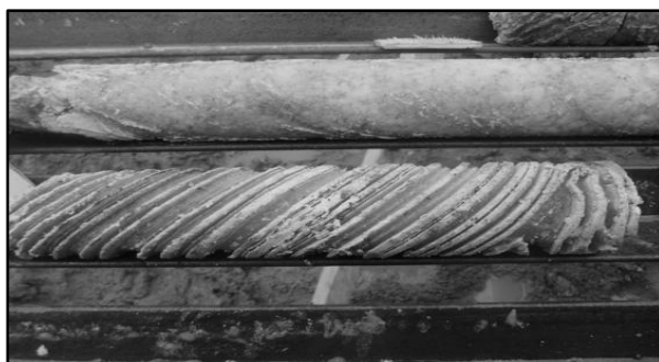
Рис. 7.7. Избирательное разрушение керна в солях Жилинского месторождения. Актюбинская обл., Казахстан (фото М. В. Петрова)
