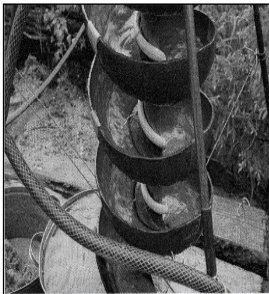
Рис. 4.6. Обогащение мелкообломочного материала на винтовом шлюзе (по Б. С. Луневу, Б. М. Осовецкому, 2009)
