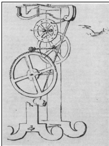
Рис. 22. Оригинальный рисунок маятниковых часов Галилея, сделанный В. Вивиани (ок.1637)
