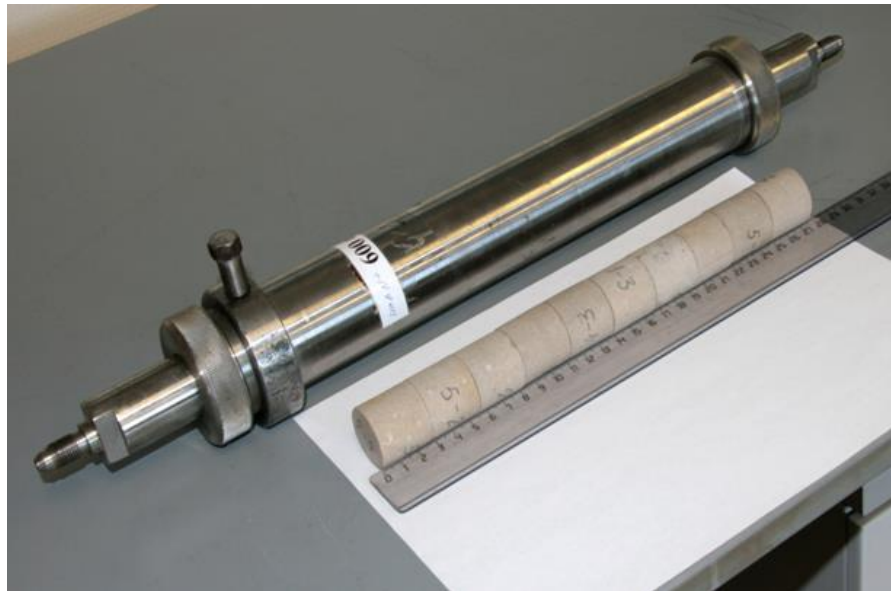
Рисунок 1.3.2 – Составная модель пласта и кернодержатель высокого давления
