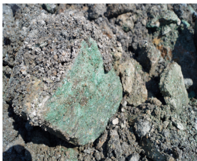
Рисунок 4. Шамозитовые метасоматиты преобразованной коры выветривания объекта №7.
