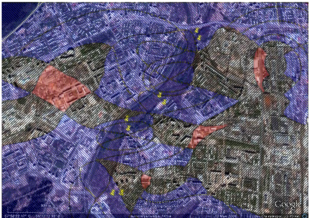
Рис. 3. Коэффициенты изменения скорости ветра при западном воздушном потоке (5-8м/с) для участка р. Данилиха
