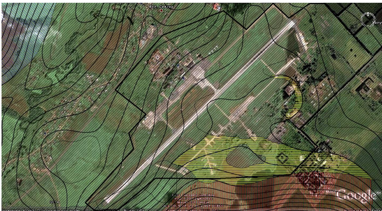
Рис. 9. Коэффициенты изменения скорости ветра при западном воздушном потоке (2-4 м/с) для АМСГ Пермь
