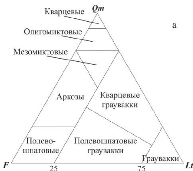
Рис. 2.2. Классификационная диаграмма песчаных пород (а) (Шванов, 1987) и диагностическая диаграмма геодинамических обстановок областей сноса песчаных пород (Dickinson, 1983) (b). Qm – кварц монокристаллический; F – полевые шпаты, как плагиоклазы, так и калиевые полевые шпаты; Lt – любые обломки пород, в том числе кремни и микрокварциты
