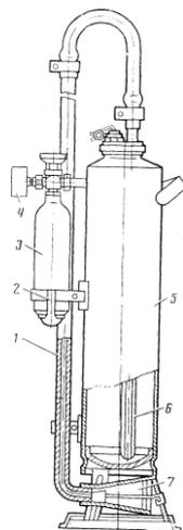
1- удлинитель; 2- кронштейн; 3-баллон с рабочим газом; 4- манометр; 5- корпус; 6- сифонная трубка; 7- насадок.
