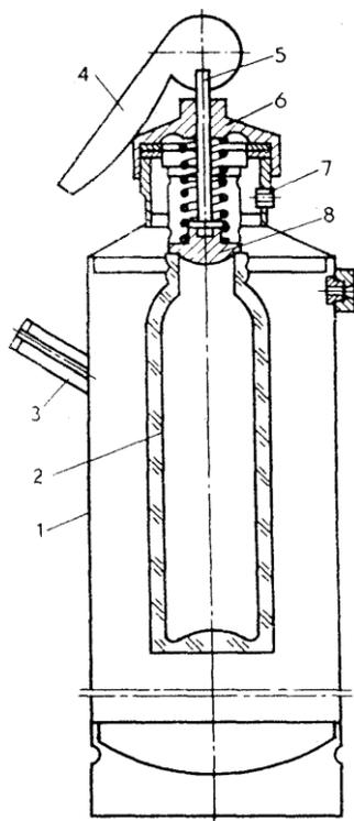
1- корпус; 2- стакан с кислотной частью заряда; 3-ручка; 4- рукоятка; 5- шток; 6- крышка; 7- спрыск; 8- клапан.
