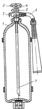
1- баллон; 2- предохранитель; 3- маховичок вентиля-заопра; 4- металлическая пломба; 5- вентиль; 6- поворотный механизм с раструбом; 7- сифонная трубка.
