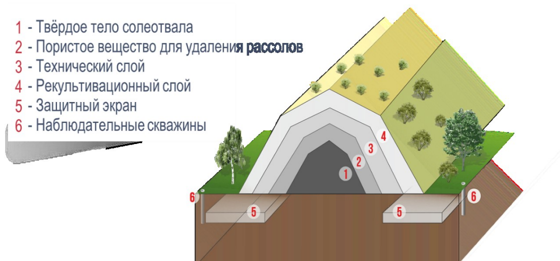
Рис. 9.3. Схематическая конструкция рекультивируемого солеотвала
