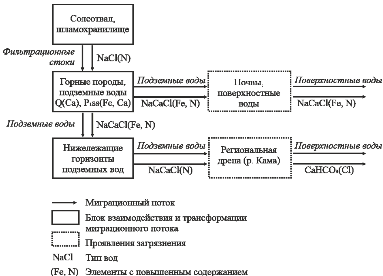
Рис. 8.44. Модель техногенного миграционного потока в окружающей среде при разработке Верхнекамского месторождения калийных солей
