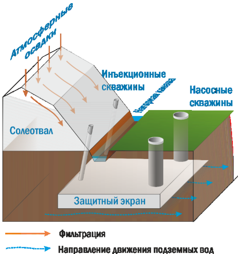
Рис. 9.2. Создание защитных экранов путем осаждения водонерастворимых солей кальция в районах солеотвалов
