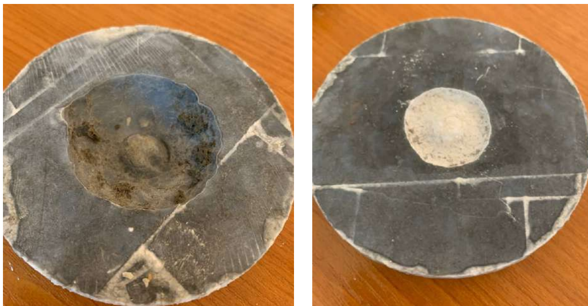
Рис. 4. Вид образцов после эксперимента (слева – интенсивный поток, справа – медленный поток)
