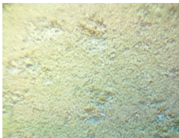
1г – микроструктура поверхности покрытия в электролите с добавлением карбамида (40 г/л)
