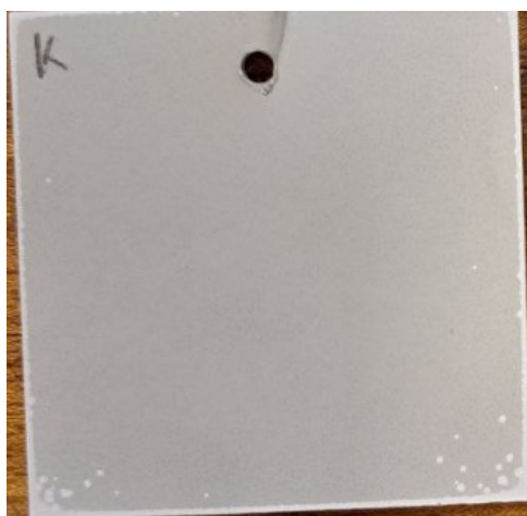
1в – поверхность покрытия в электролите с добавлением карбамида (40 г/л)
