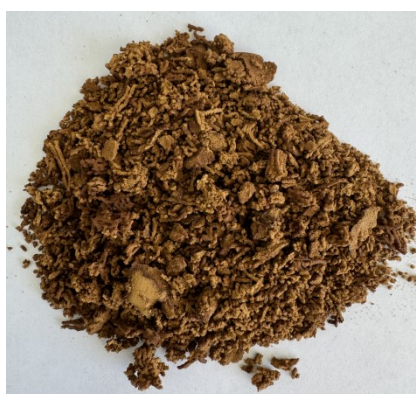
Рис. 3 Сухой экстракт манжетки мягкой травы после сушки в псевдооживленном слое с предварительной грануляцией
