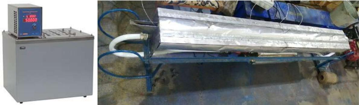
Рисунок 23 – Жидкостные термостаты: слева – лабораторный термостат Т-2, справа – полевой мобильный калибровочный стенд
