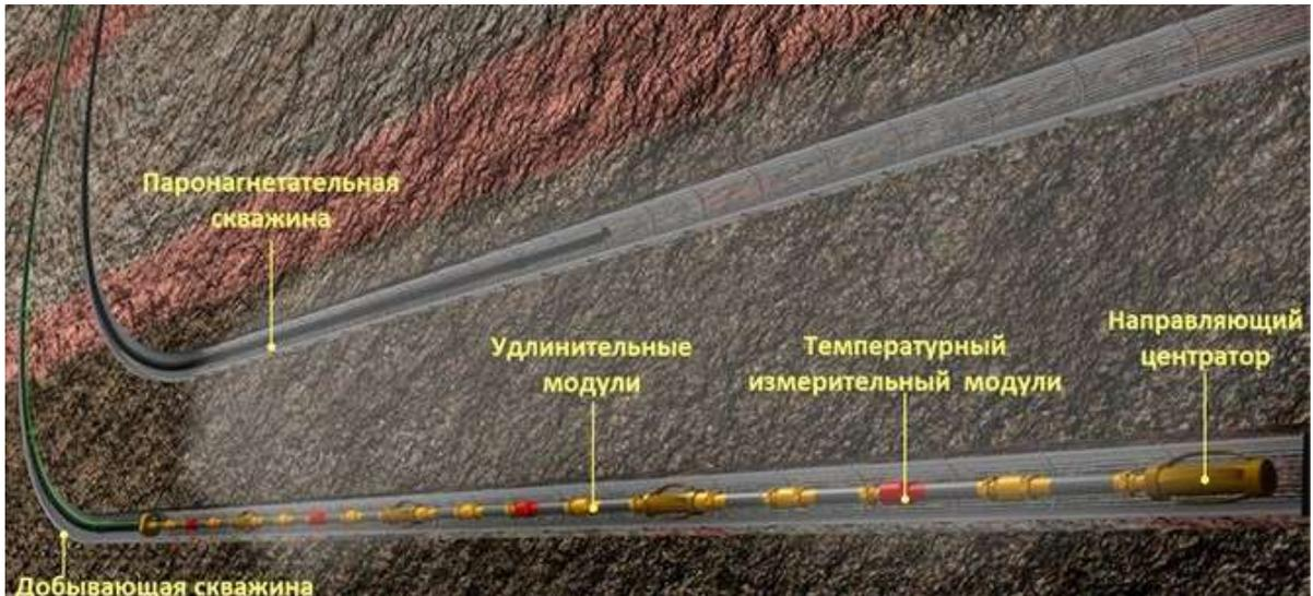
Рисунок 17 – Термокаса «Tota Systems» в добывающей горизонтальной скважине
