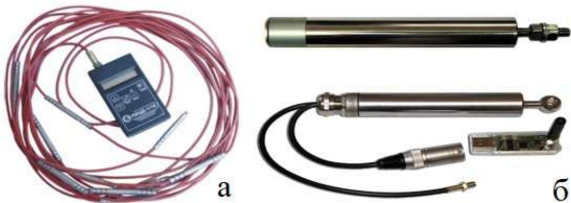
Рисунок 16 – МЦДТ: коса (а), записывающие и передающие устройства (б)
