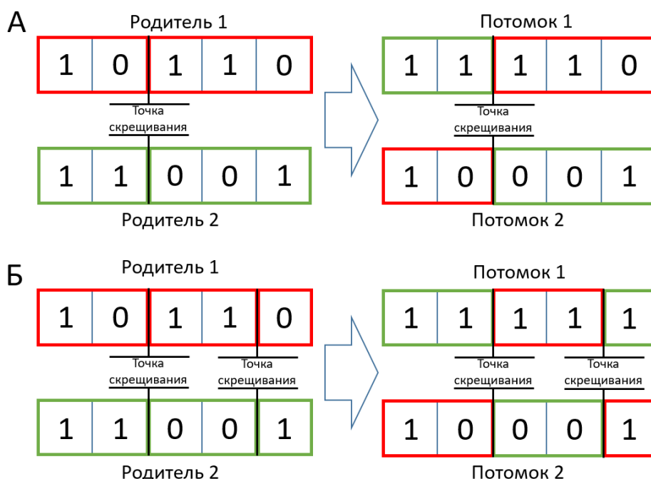
Рисунок 3.3.2 – Схема оператора скрещивания в случае с одной точкой скрещивания (А), двумя точками скрещивания (Б)
