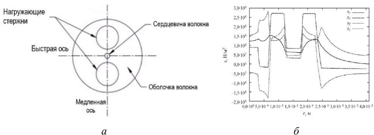
Рисунок 1.2 – Поперечное сечение ОВ типа «Панда» (а) и эпюры остаточных напряжений от радиуса ОВ [16] (б)
