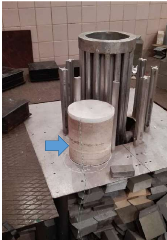
Рисунок 2.11 – Фотография установки ГУТ-200 М непрерывного гамма-излучения и термостата (отмечен стрелкой) с образцом ОБ в калиброванной по дозе излучения точке
