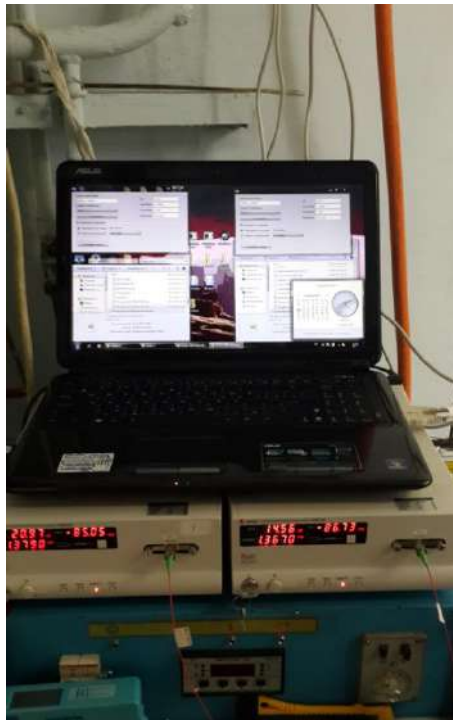
Рисунок 2.13 – Рабочее место регистрации данных с РЕМ-330 за биологической защитой
