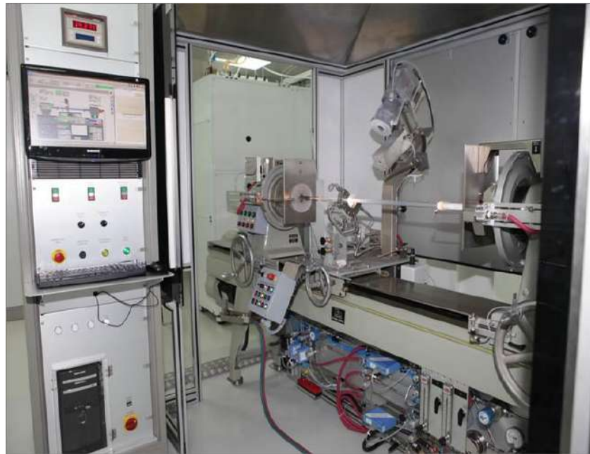
Рисунок 2.5 – Фотография станка MCVD в ПАО «ПНППК»
