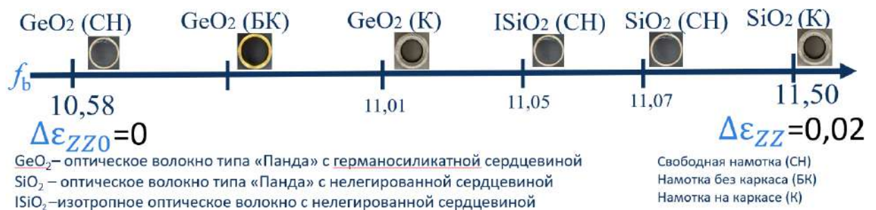
Рисунок 2.9 – Значение частоты Бриллюэна для ОВ с разной степенью напряженно-деформированного состояния кварцевого стекла сердцевинной
